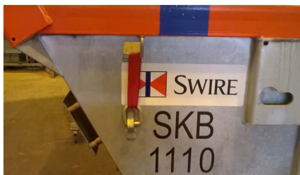
Bilde 2: tredd stropp fra innsiden
